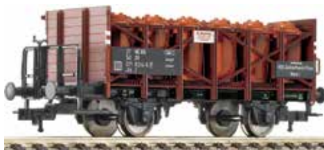
Säuretopfwagen, eingestellt bei der DR. Mit Bremserbühne.
