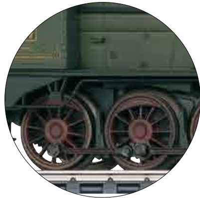
Estabilidad en las curvas incluso en aquellas de radio R1 gracias a los ejes desplazables lateralmente
