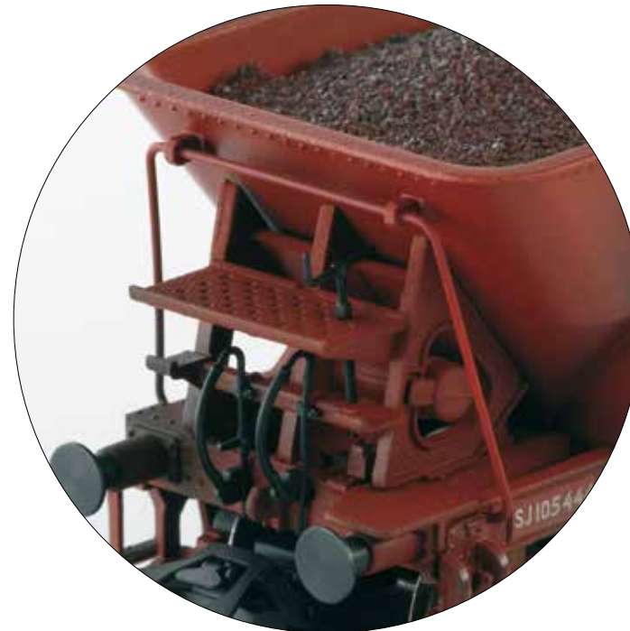
Todos los vagones con plataforma de guardafrenos y manivela de freno
