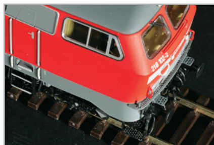
Durchbrochene Trittstufen aus Ätzteilen
