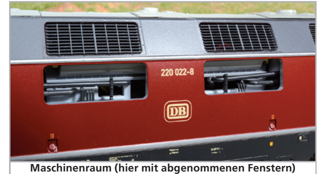
Durchbrochene Lüftergitter; separat eingesetzte Rotoren
