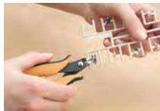
Figur vom Spritzling abschneiden ...
