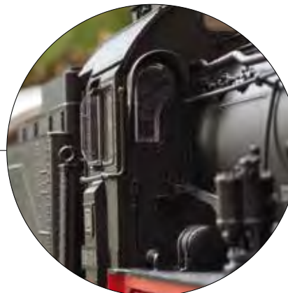
Antigua P8 prusiana con cajón de Indusi colocado a posteriori
