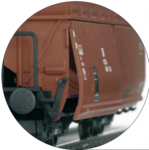
Compuertas de descarga móviles como en el modelo real
