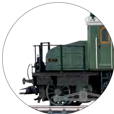
Transmisión via falso árbol como en el modelo real
