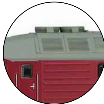
Lüftergitter unterschiedlich, je nach Bauserie
