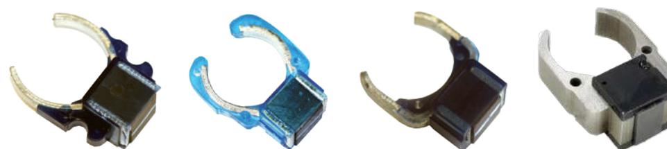
Für den Umbau alter Märklin®-Allstrommotoren benötigen Sie einen Permanentmagneten. Er ersetzt die bisherige Feldwicklung und verhilft Ihren alten Loks in Verbindung mit einem LokSound oder Lok-Pilot Decoder zu einem Fahrverhalten, welches Sie den Loks nie zugetraut hätten! Wir liefern vier verschiedene Magnete. Welcher genau benötigt wird, hängt vom Ankertyp ab. Die Nummer des Ankers finden Sie im Ersatzteilblatt, welches Sie auch online auf der Märklin®-Homepage abrufen können.
