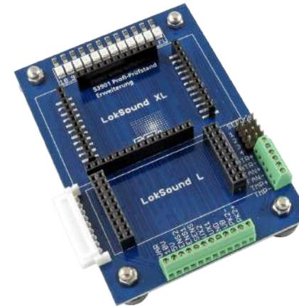
Der Profi-Prüfstand 53900 kann bei Bedarf um die Profi-Prüfstand Extension ergänzt werden: Seitlich angedockt an den Profi-Prüfstand 53900 können nun auch die Großbahn-Decoder komfortabel getestet werden.
