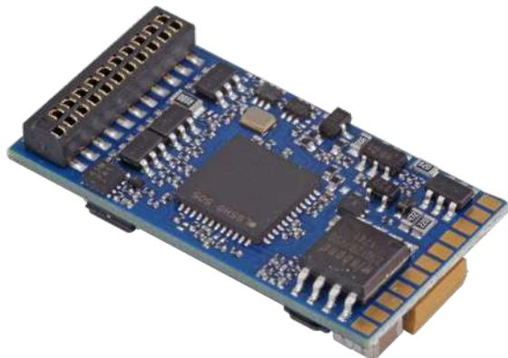
Der LokSound 5 ist das wichtigste Mitglied der LokSound-Familie. Durch die Kombination aus Digitaldecoder und Soundmodul auf einer Leiterplatte erreichen wir Abmessungen von nur 30 mm x 15,5 mm und kann somit in nahezu jede Loks der Spurweiten H0 und 0 eingebaut werden. Er sorgt für den Antrieb des Modells, die Lichtsteuerung und die Geräuschsteuerung.
