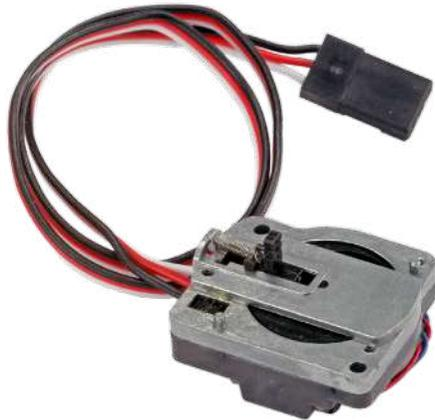
Dieses Linearservo in den Dimensionen 26mm x 22,5mm x 10,8mm ist hauptsächlich für den Einbau in E-Loks gedacht, um dort Stromabnehmer nachträglich heb- und senkbar zu machen. Die Mechanik ermöglicht einen sehr leisen, ruhigen Lauf und vermeidet die Geräuschentwicklung handelsüblicher Servos. Der Servoweg beträgt ca. 4,5mm.
