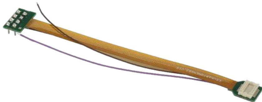
In manche H0-Loks mit der „alten“ 8-pol-Schnittstelle nach NEM-652 passt aus Platzgründen oft kein H0-Decoder. Mit Hilfe dieser Flex-Leiterplatte, die sich nahezu beliebig falten und auf Länge bringen lässt, können Sie einen modernen, kleinen N-Spur-Decoder mit Next18-Schnittstelle einbauen.
