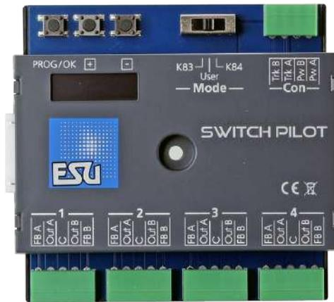
SwitchPilot 3 Decoder sind für den stationären Einsatz an Ihrer Anlage optimiert und können herkömmliche Doppelspulen-Weichenantriebe, Lichtsignale, magnetische Entkupppler, Glühbirnen oder andere stationäre Verbraucher schalten.
