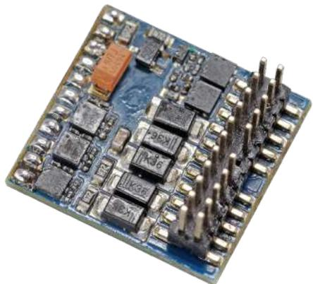
Der LokPilot 5 Fx DCC ist ein Funktionsdecoder ohne Motorausgang und somit perfekt für den Einbau in Steuerwagen oder Funktionsmodellen geeignet. Als „Zwillingsbruder“ des LokPilot 5 Fx teilt er sich dessen Eigenschaften und auch die grundsätzlichen Eigenschaften aller anderen LokPilot 5 Decoder, ist jedoch ein reiner DCC-Decoder.
