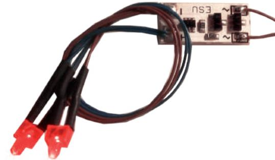
Die kleine, nur 15 mm x 7 mm große Schlusslichtplatine bietet zwei komplett verkabelte, rote LEDs zum Einbau in Ihre Schlusswagen. Sie kommt einbaufertig komplett mit Anschlusslitzen.
