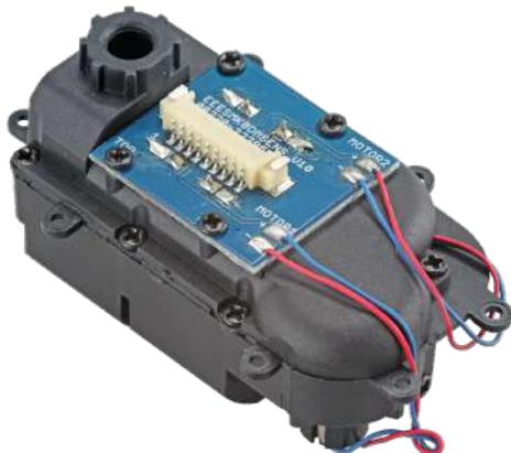
Unser Raucherzeuger „Dual klein“ ist für Fahrzeuge der Nenngrößen Spur G, Spur 1 aber auch für größere Fahrzeuge in Spur 0 geeignet. Sowohl ein Auspuffdampf als auch Zylinderdampf sind hier in einem kompakten Gehäuse integriert. Somit können Sie auch Ihre älteren Loks endlich mit einem realistischen Zylinderdampf nachrüsten.
