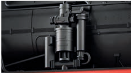
Bomba de alimentación tipo Knorr KT1-250 con sistema de control Tolkien
