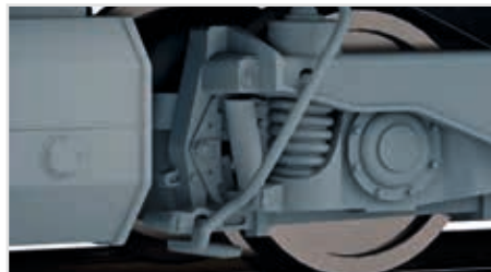
Reproducción elaborada del sistema de frenos y los tubos de arena
