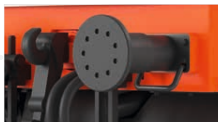
Tampones con barras de agarre sobresalientes
