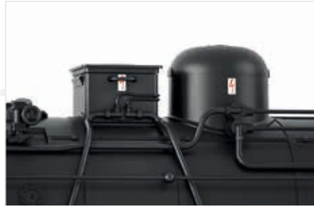
Realización precisa de la caja de arena y del domo vapor
