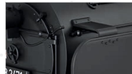
Deflectores con auténtico espesor de material
