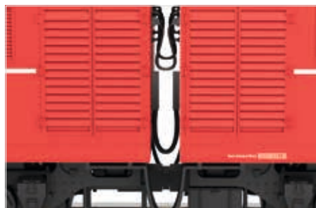
Realización precisa de toda la tubería de conexión entre las dos partes de la locomotora
