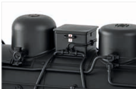
Domo de vapor, caja de arena y domo de alimentación fieles al modelo original
