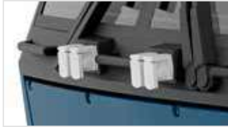
Filigrane extra angesetzte Griffstangen, UIC-Dosen und Scheibenwischer
