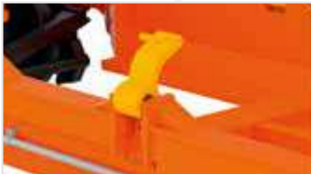
Klappriegel beweglich für Transport von Containern
