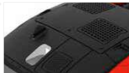
Filigrane Gravur der Lüftungsgitter, separat angesteckte Antennen
