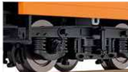
Vorbildgerechte Drehgestelle der Bauart Görlitz V modifiziert
