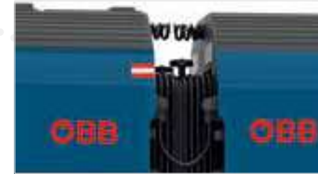
Nachbildung aller Übergangsleitungen zwischen den Wagen
