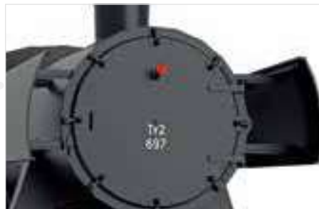
Rauchkammertüre in flacher Ausführung
