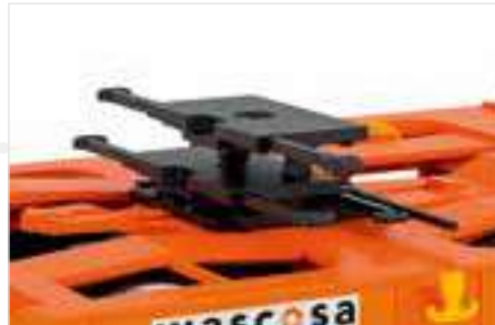
Mehrteilig ausgeführter Stützbock
