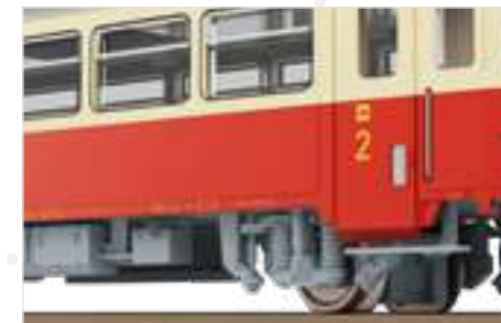
Angesetzte Griffstangen neben den Türen
