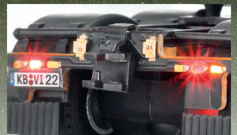
Luces traseras/de freno/intermitentes y luces de marcha atrás, transmisor infrarrojo
