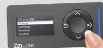
Konfiguration direkt mit Tasten und Display
